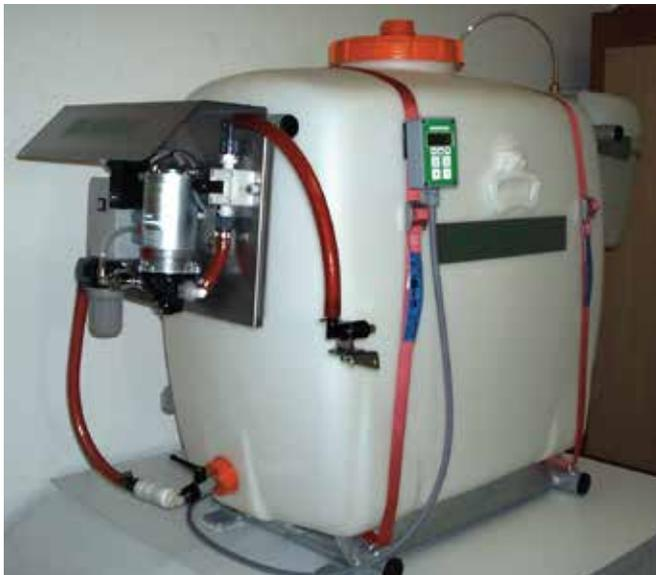
Mit diesem Dosiergerät wird das KOFASIL S Konzentrat kontinuierlich einem Wasserstrom zudosiert und ausgebracht. Bei sich verschlechternden Witterungsbedingungen kann problemlos ein chemisches Siliermittel der Wirkungsrichtung 2 (z. B. MAIS KOFASIL LIQUID oder KOFASIL STABIL) appliziert werden.
